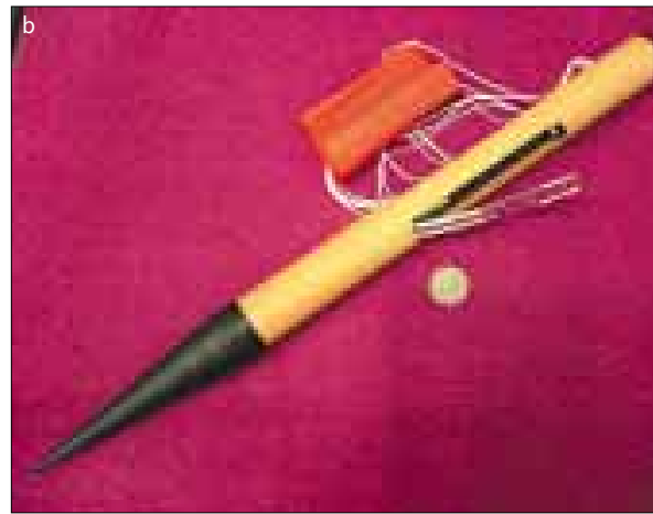
Figure 3 - Le système de « bouée à fusées » ( Rocketsonde-Buoy ). a - Schéma de la bouée ancrée. Chaque fusée fait environ 5 cm de diamètre et 70 cm de long. Elle propulse une dropsonde à une altitude maximale d'environ 8 km. La dropsonde retombe ensuite doucement, tout en transmettant ses observations météorologiques (température, humidité, pression et vent par GPS) à la bouée, qui les retransmet vers un satellite. b - La dropsonde (modèle Vaisala) avec son parachute et ses capteurs. (Courtesy Roland Stull, University of British Columbia, Canada)
