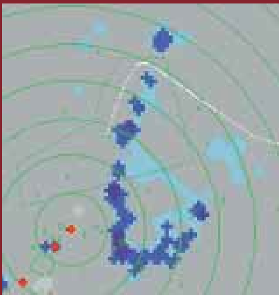
Figure 5 - Image Signora superposée avec la trajectoire d'un avion, le 2 août 1998 à 14 h 50 UTC. Les cercles sont tracés de 10 km en 10 km autour du centre de contrôle. La trajectoire suivie par l'aéronef (trait pointillé blanc) indique clairement que celui-ci évite la zone orageuse.
