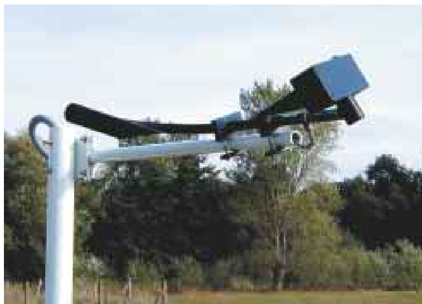
Capteur de temps présent opérationnel sur l'aérodrome de Dinard. (Photo Météo-France)
