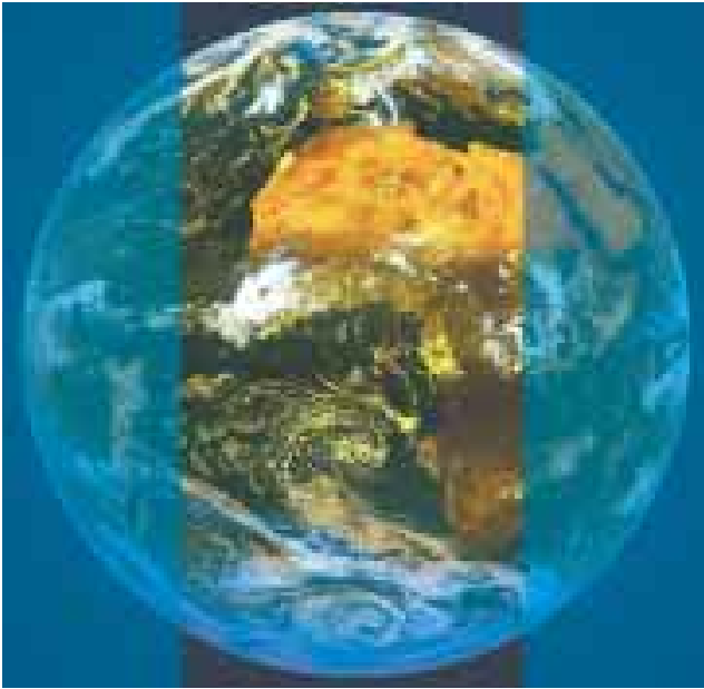
Deux configurations possibles pour le domaine HRV (High Resolution Visible) du satellite MSG , modifiable en vol. Compte tenu de la très forte résolution spatiale, il est nécessaire de restreindre le domaine pour limiter le volume total de données à transmettre depuis le satellite. La configuration de droite permet une bonne couverture de l'océan Indien pour les besoins de l'île de la Réunion.
