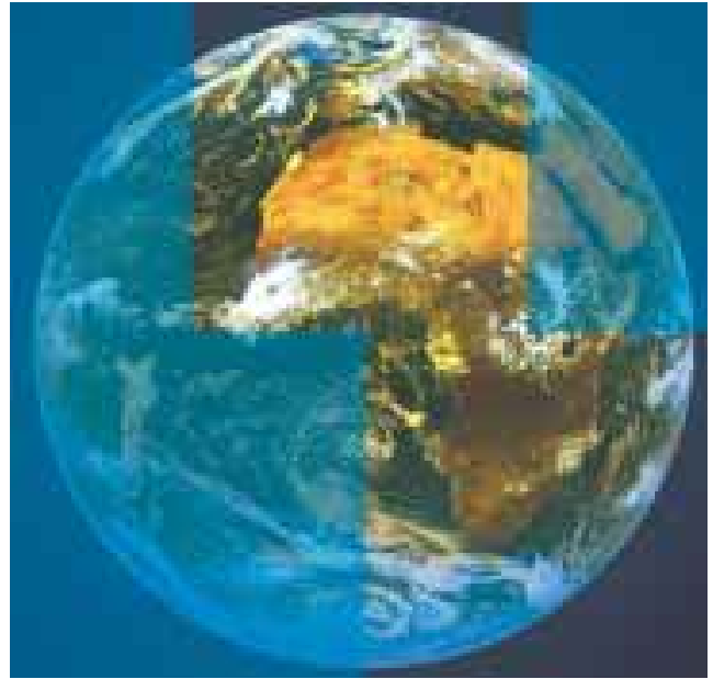
Deux configurations possibles pour le domaine HRV (High Resolution Visible) du satellite MSG , modifiable en vol. Compte tenu de la très forte résolution spatiale, il est nécessaire de restreindre le domaine pour limiter le volume total de données à transmettre depuis le satellite. La configuration de droite permet une bonne couverture de l'océan Indien pour les besoins de l'île de la Réunion.
