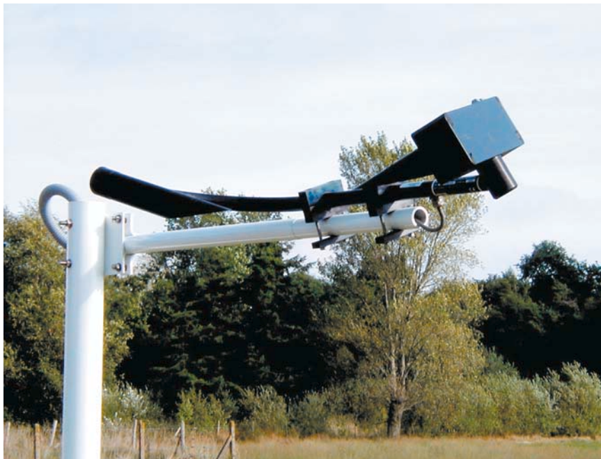
Un capteur de temps présent sur l'aéroport de Dinard. (Photo Météo-France)
