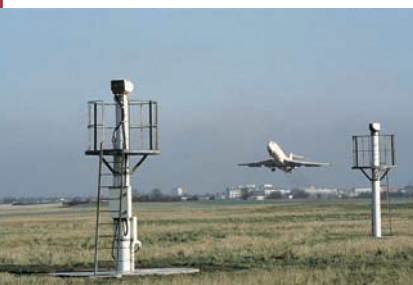
Un transmissomètre avec son émetteur et son récepteur. (Photo Météo-France)
