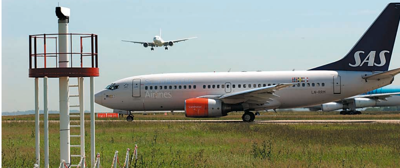
L'un des éléments d'un transmissomètre sur une piste de Roissy. (Photo Météo-France, P. Taburet)
