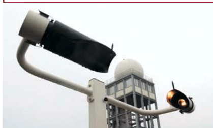
Le diffusomètre Degréane DF20. En arrière-plan, la tour radar de Trappes. (Photo Météo-France, P. Taburet)
