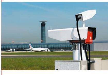
Le luminancemètre dirigé vers le ciel, juste au-dessus du transmissomètre. (Photo Météo-France, P. Taburet)
