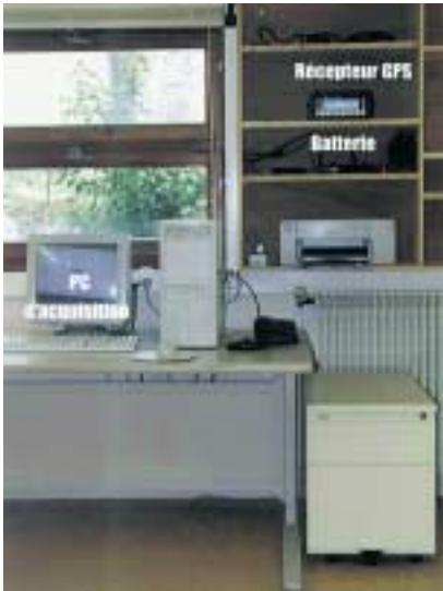
Figure 11 - Un récepteur GPS et son PC d'acquisition utilisé pour le téléchargement, la diffusion et l'archivage quotidien des données. (Photo E. Doerflinger)
