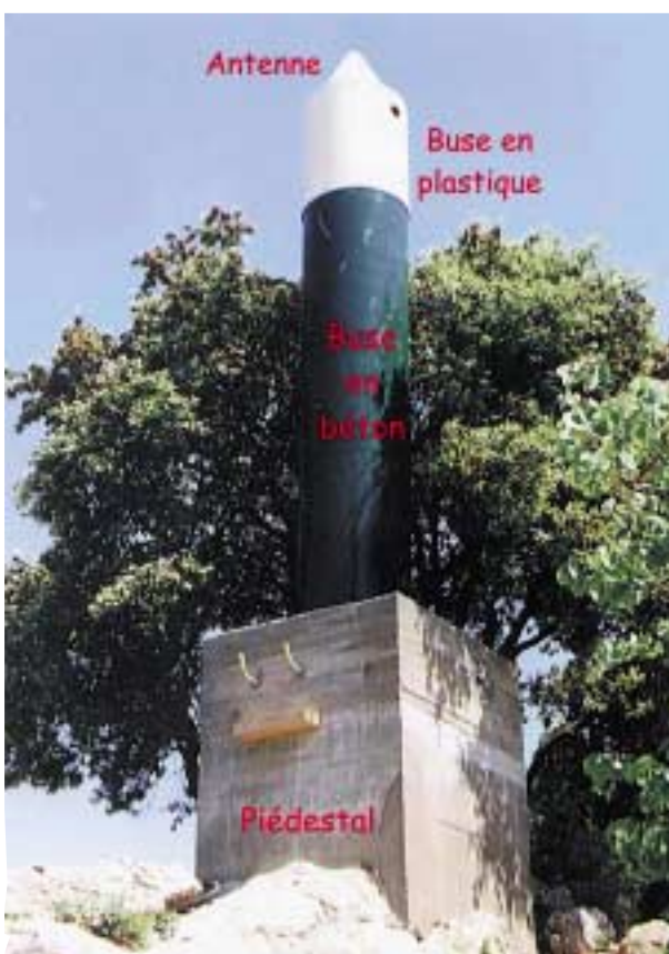
Figure 10 - Un monument géodésique, constitué d'un piédestal ancré dans les calcaires et surmonté d'un pilier en béton. Le pilier est entouré d'une buse en béton (vert) et d'une buse en plastique (blanc). L'antenne GPS se trouve en haut du pilier (cône blanc). (Photo E. Doerflinger)
