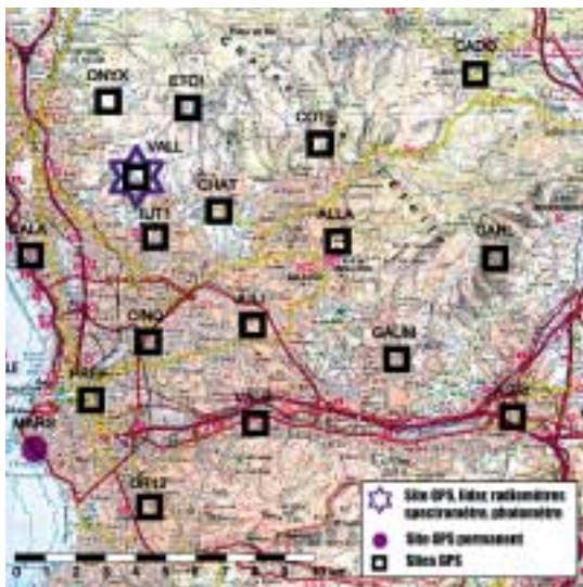
Figure 15 - Zone de déploiement du réseau tomographique GPS de 17 récepteurs dans la région de Marseille. Localisation de la station GPS permanente de Marseille (MARS) et des autres instruments de mesure de la vapeur d'eau atmosphérique.
