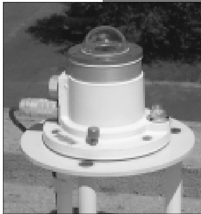
Radiomètre UV-B Yankee Environmental Systems. Bande spectrale 280-320 nm. (Photo Météo-France, J.-P. Morel)
